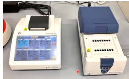
②リアルタイム濁度測定装置LoopampEXIA® 栄研化学 鼻咽頭ぬぐい液、唾液
